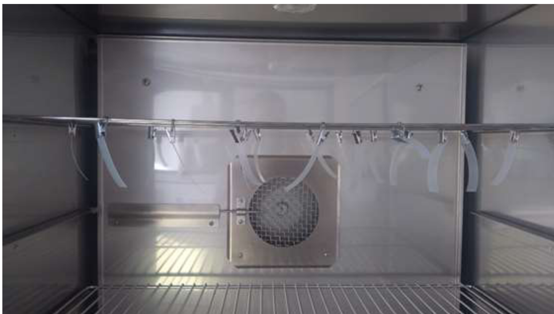
Obr. 19: Vzorky zavesené v sušiarňi HORO na stanovenie termooxidačnej stability
