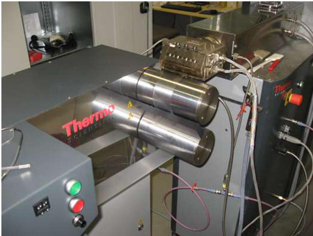
Obr. 16: Používaná chill-roll technológia na prípravu fólií.
