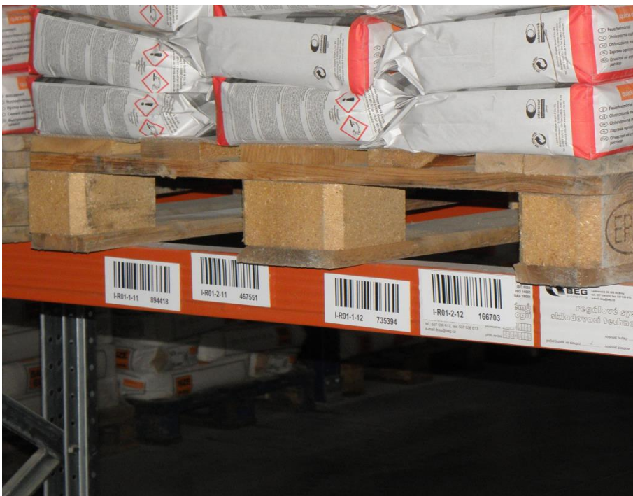
Obrázek 2: Označení dělených paletových míst pomocí čárových kódů Zdroj: vlastní fotografie
