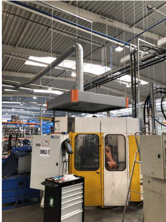
Obrázek 6.20: Odsávací hlavice nad svařovací buňkou
