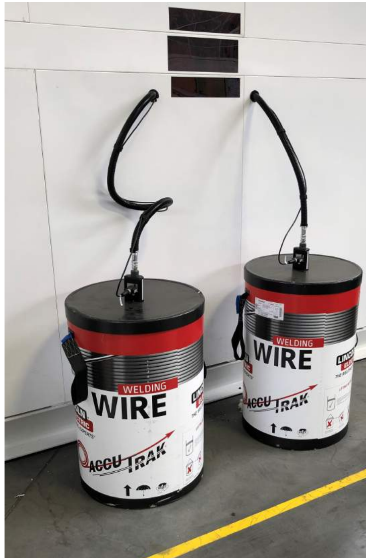
Obrázek 6.10: Zásobníky na přídatný drát s vývodem do svařovací buňky
