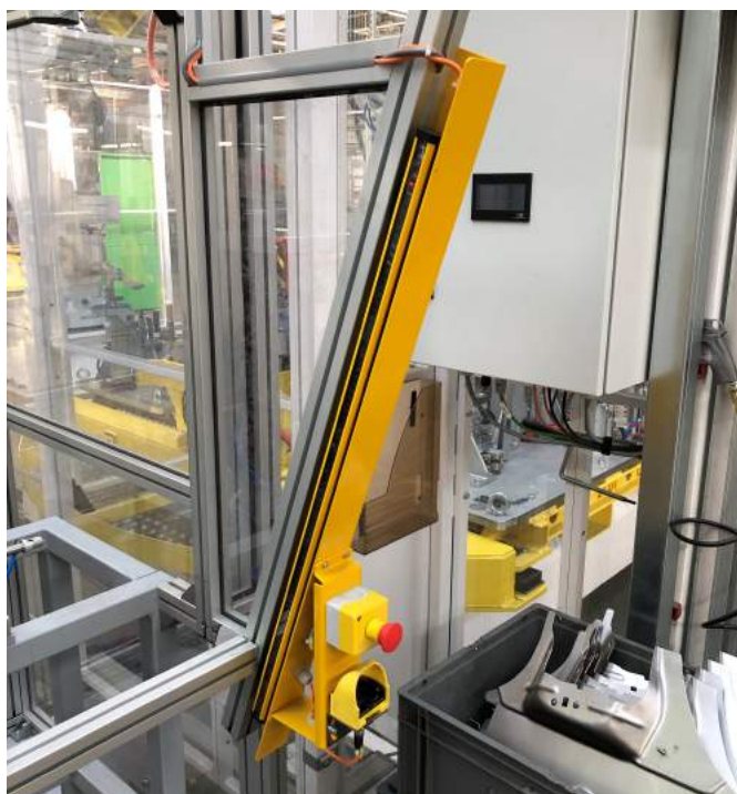
Obrázek 6.17: Detail na jeden panel světelné závory
