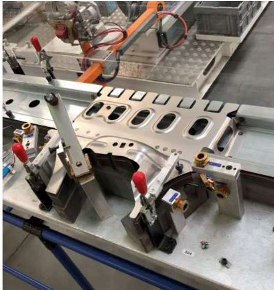
Obrázek 7.2: Svařenec upevněný v otočném stole
