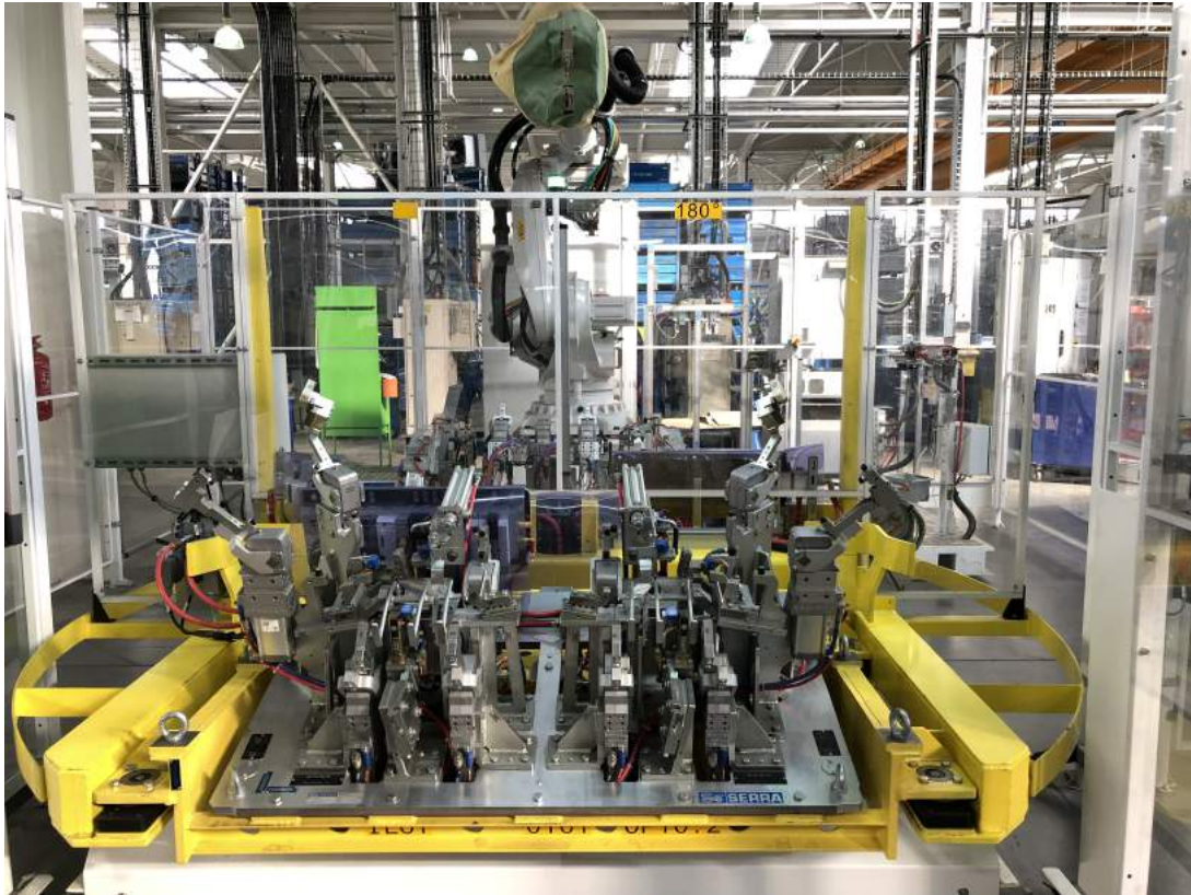
Obrázek 6.12: Sekvenční otočný stůl s kleštinovým upínáním
