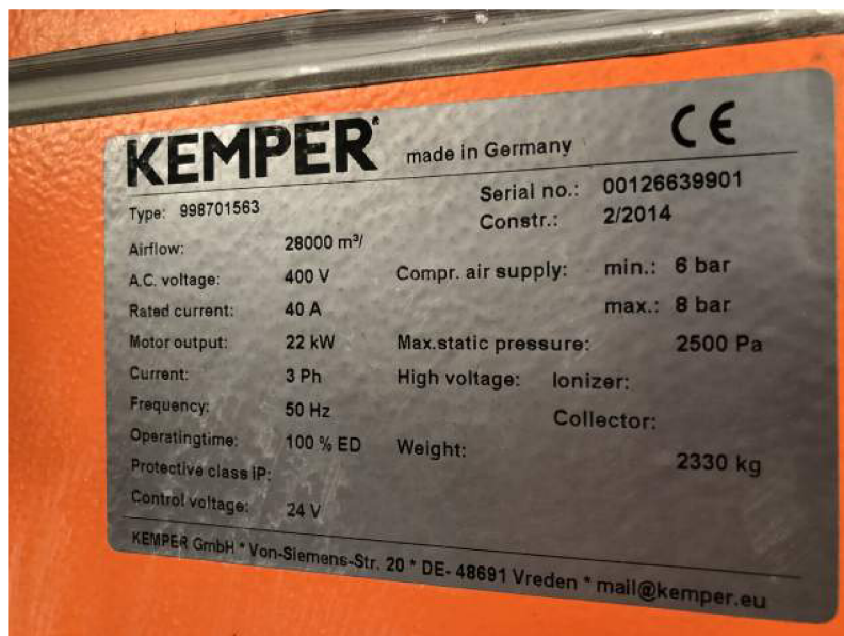
Obrázek 6.21: Štítek s provozními hodnotami
