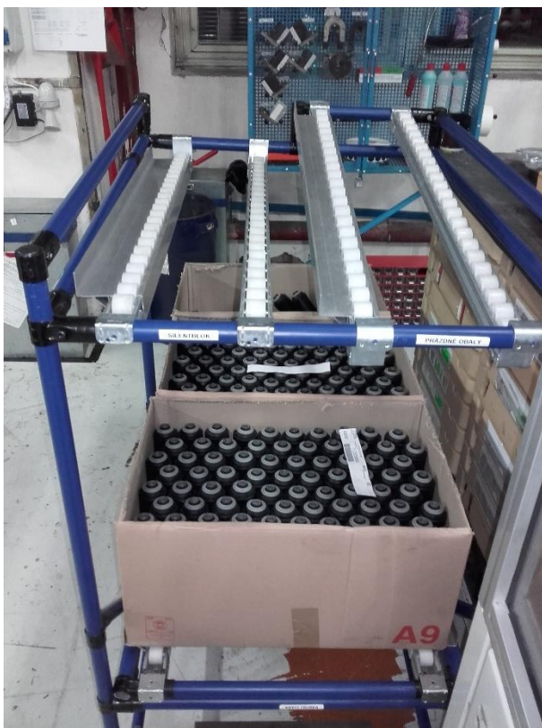
Obr. J4: Trubkový regál na silentbloky a krycí trubky Zdroj: vlastní zpracování.
