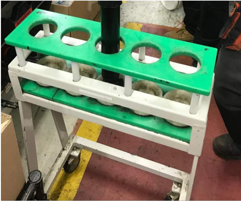
Obr. J5: Vozík na odkládání tlumičů mezi druhým a třetím pracovištěm na kompletační lince PSA Zdroj: vlastní zpracování.
