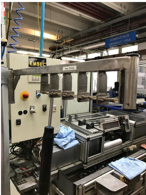
Obr. J2: Držák na tlumiče po nalisování dorazu Zdroj: vlastní zpracování.
