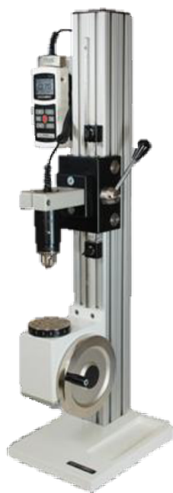
Obrázek 5: Mark-10 TSTH manuální testovací stojan [4]
