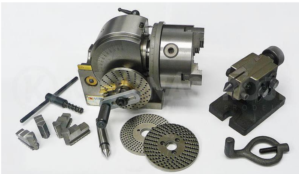
Obrázek 6: Dělicí přístroj s příslušenstvím BS-0-J, TOS UIG 125/3 - 2 [7]
