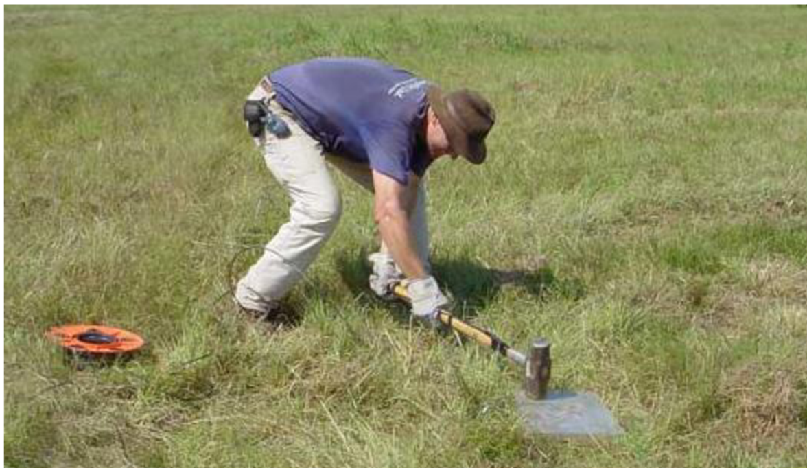
Obr. 3.8. Úderová seismika pomocí kladiva [26]
