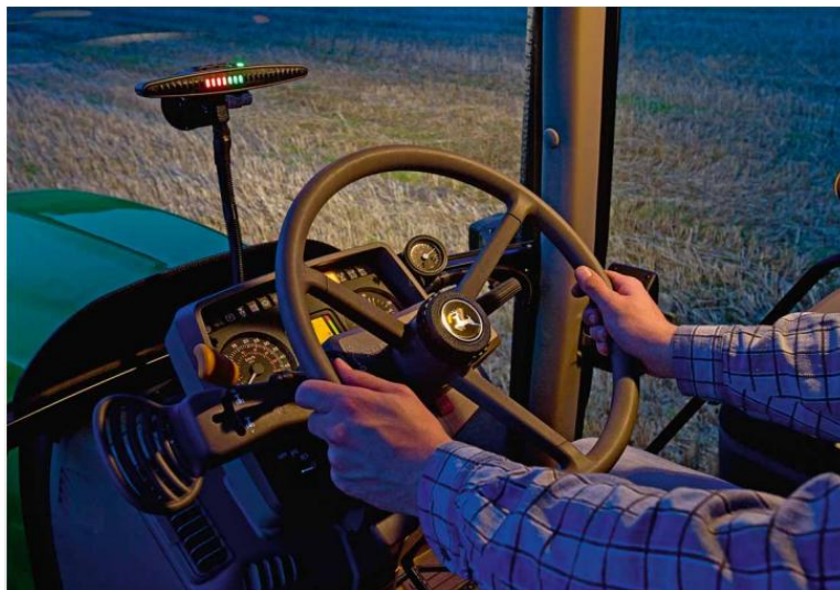
Obrázek 2.11 Manuální naváděcí systém (Systém GreenStar Světelná Lišta)
