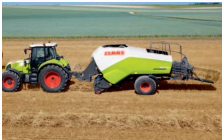
Obrázek 2.20 Sběrací lis při práci
