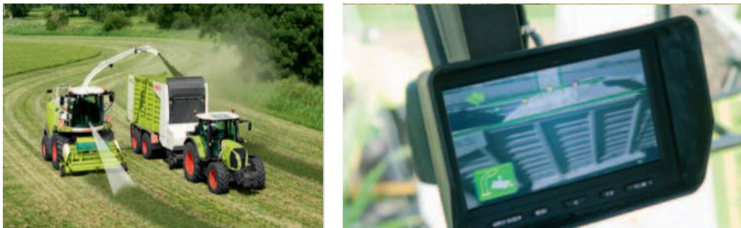
Obrázek 2.19 Kamera umístěná na odhazové koncovce
