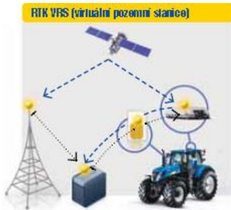
Obrázek 3.2 Schéma RTKS VRS
