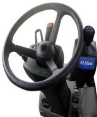
Obrázek 2.12 Systém asistovaného řízení
