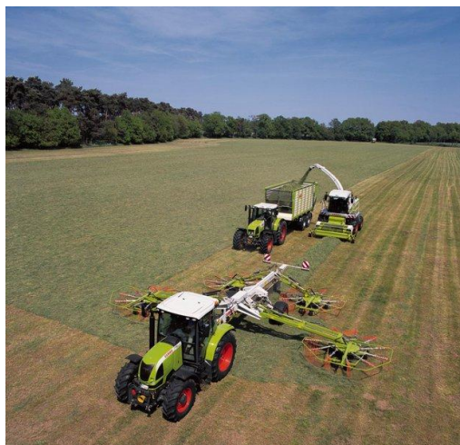
Obrázek 2.17 Shrnovač + samojízdná řezačka při práci
