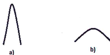
Obr. 15: Uložení vláken v netkané textílii: a) převážně vertikální, b) převážně horizontální
