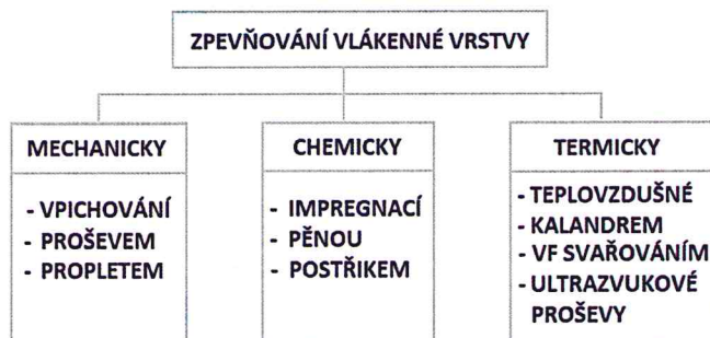
Obr. 4: Struktura zpevňování vláknenné vrstvy [5].
