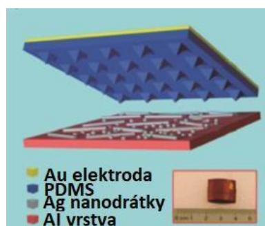
Obrázek 28 Struktura triboelektrického senzoru s nanodrátky [42]
