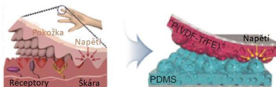
Obrázek 30 Triboelektrický senzor inspirovaný strukturou lidské kůže [25]
