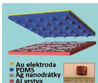
Obrázek 28 Struktura triboelektrického senzoru s nanodrátky [42]
