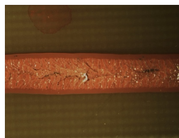
Obrázek 4.6 - PETG po mechanickém lisování
