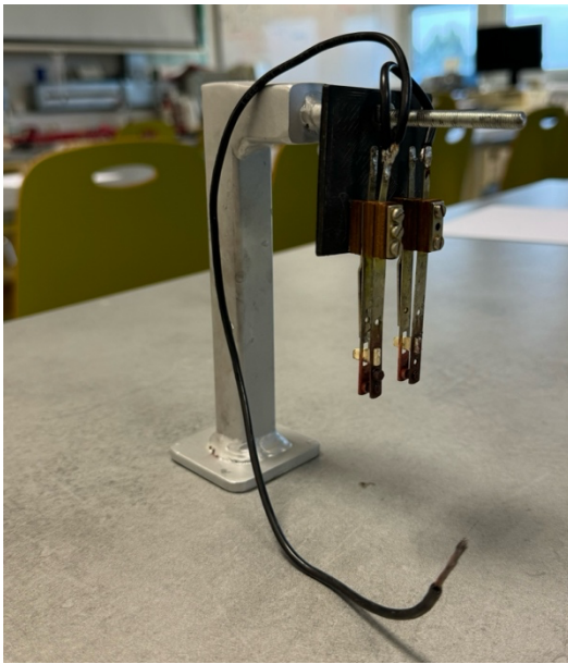
Obrázek 4.20 - Držák na destičky pro galvanické pokovování
