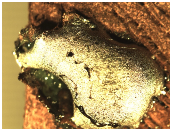
Obrázek 4.36 - Pájený spoj na destičce ABS
