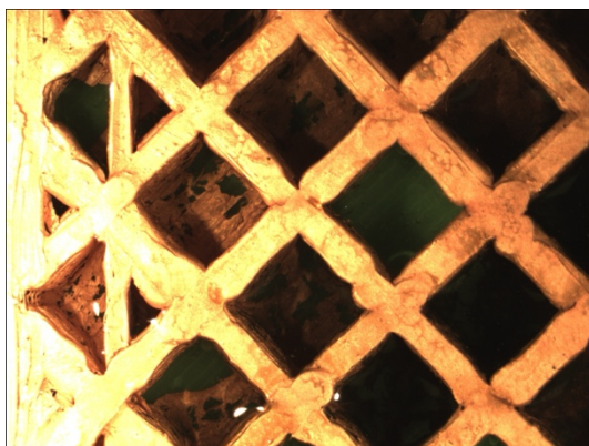
Obrázek 4.25 – ABS – galvanická Cu, přiblížení 45x
