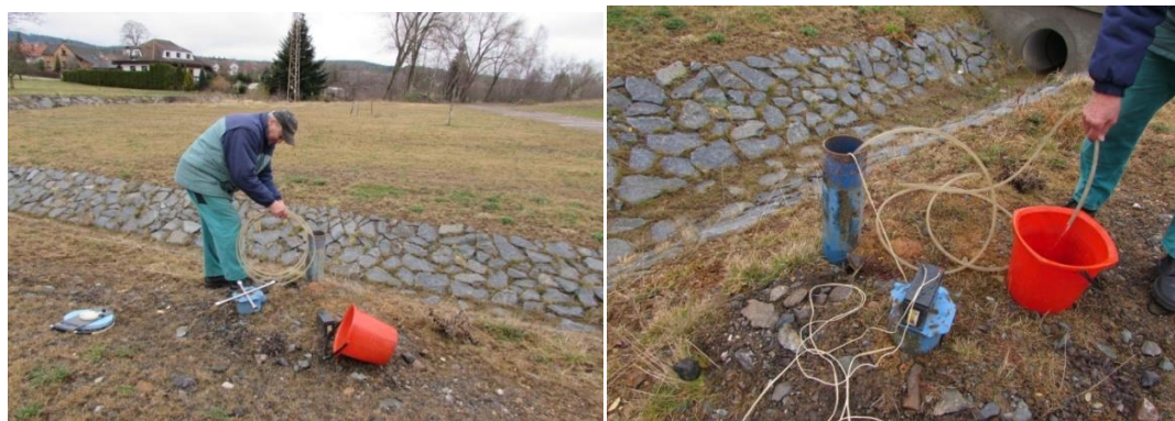
Obrázek č. 13 a 14 Odběry podzemní vody (foto Alena Štichová)
