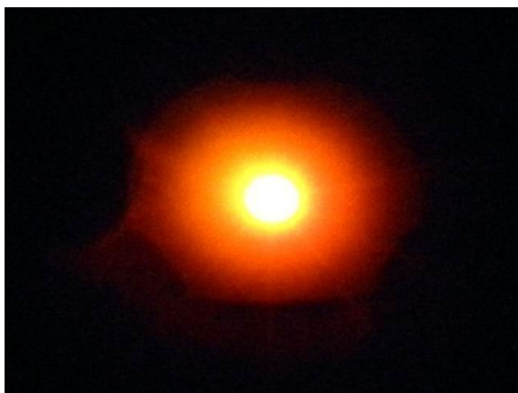
Obr. 5.1. jednosvazkové superkontinuum generované při \lambda_p = 613 nm
