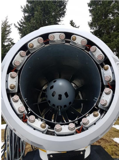
Obr. 6: Přední část děla s nukleátory a vodními tryskami (Jan Fořt, 2020)
