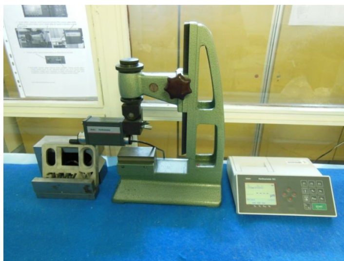
Obr. 4.17 Zařízení MAHR Perthometr M2 s posuvovou jednotkou PFM.
