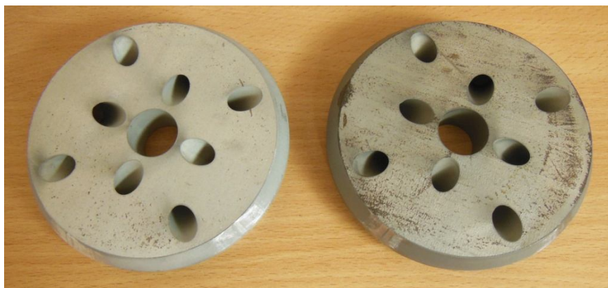
Obr. 3.13 Vzorek kolečko po manuálním odstranění můstků.
