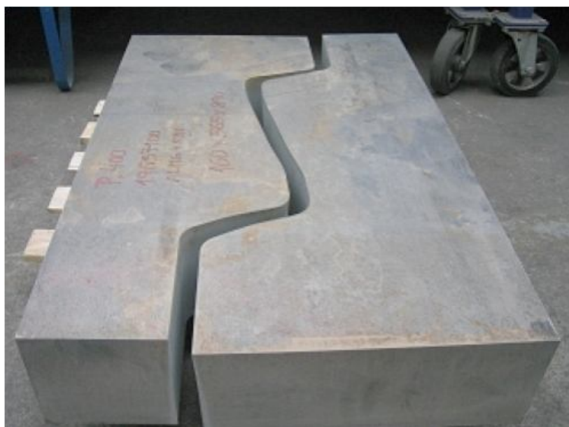
Obr. 1.27 Řez duralem tloušťky 160 mm – firma AWAC 2 .
