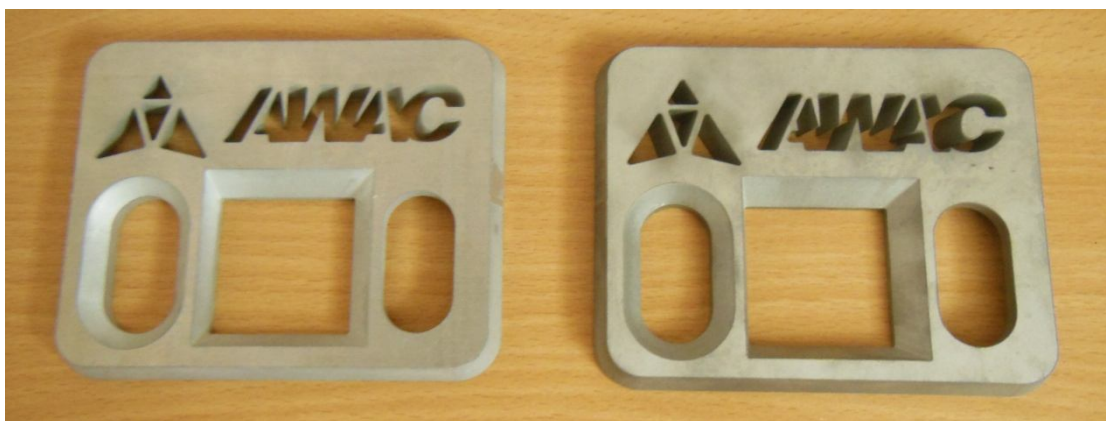
Obr. 3.14 Vzorek obdélník AWAC po manuálním odstranění můstků.
