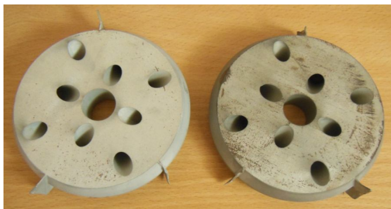
Obr. 3.12 Vzorek kolečko s pozůstatky můstků.
