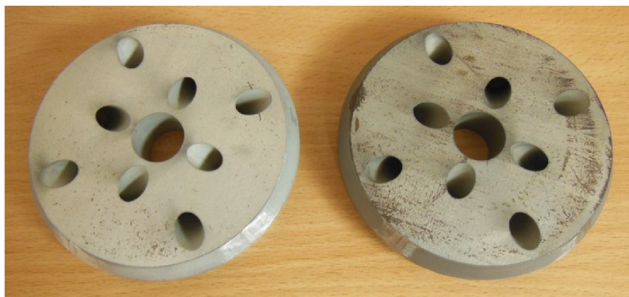
Obr. 3.13 Vzorek kolečko po manuálním odstranění můstků.
