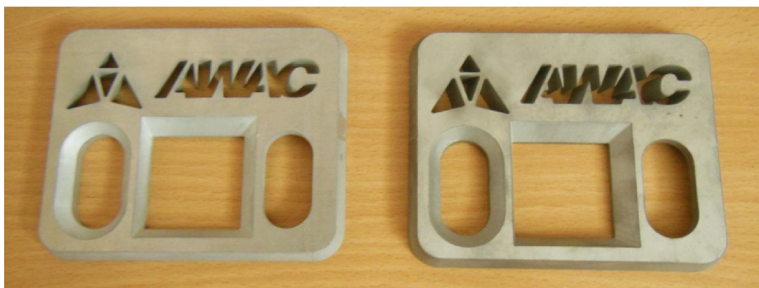
Obr. 3.14 Vzorek obdélník AWAC po manuálním odstranění můstků.
