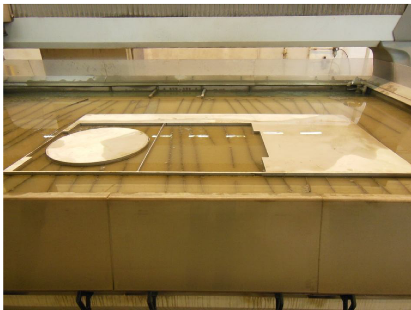
Obr. 3.11 Ustavení polotovaru na zařízení Mach 4c.
