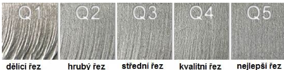
Obr. 1.22 Vizualní zobrazení stupňů kvality řezu 9 .
