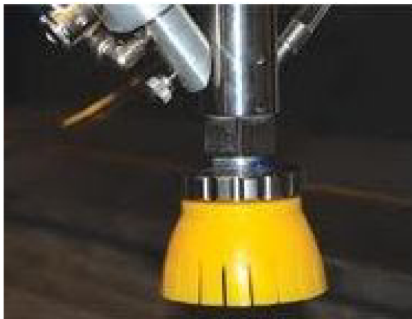
Obr. 2.10 Přípravek technologie Ultrapierce vacuum assist 41 .
