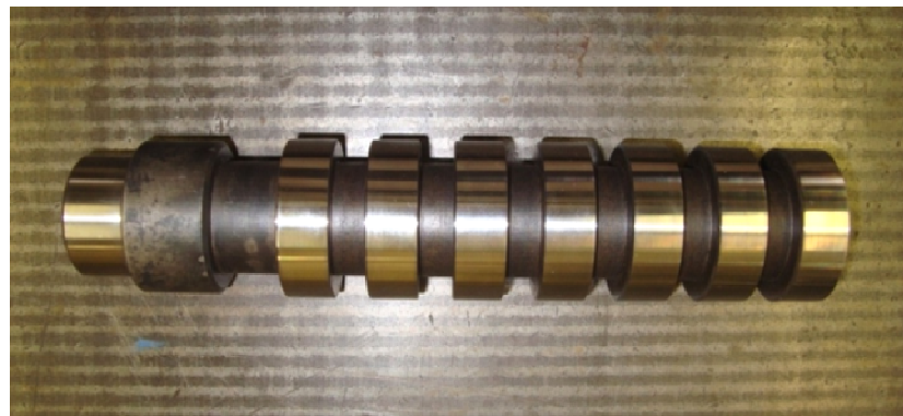
Obr. 4.5 Zkušební obrobek (materiál 14 209)
