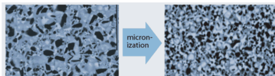
Obr. 2.5 Konvenční cermet o průměrné velikosti zrn 1,5-2mikrometrů (vlevo). Jemnozrný cermet PV7020, průměrná velikost zrna 0,6mikrometrů [21]
