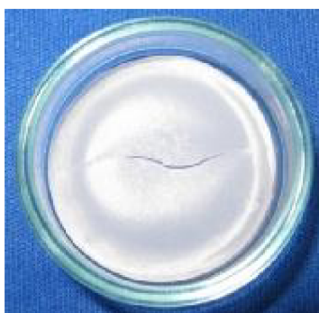
Obr. 13: Příprava polymeru. Film vzniklý odpařením 2% roztoku PCL v dichlormetanu
