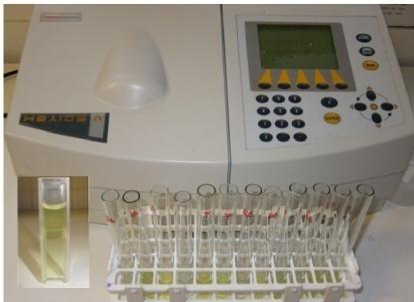
Obr. 11: Ilustrativní obrázek - spektrometrické měření lipolytické aktivity
