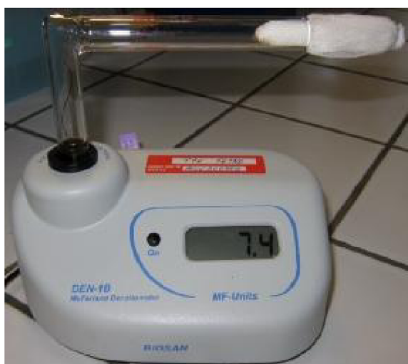
Obr. 12: Denzitometrické měření nárůstu/koncentrace biomasy
