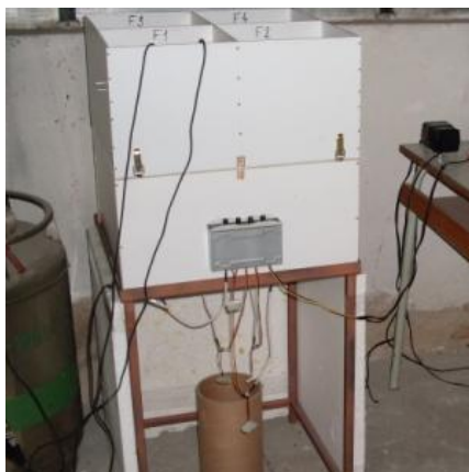
Obr. 5 Sestrojené zařízení nucené konvekce ze zdola
