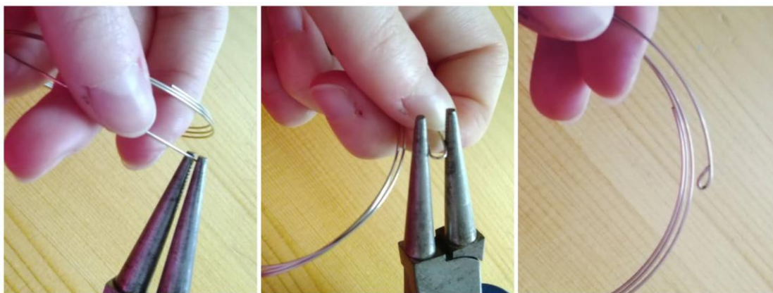
Obrázek 4: Zahnutí drátu do oka
