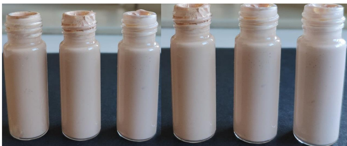
Obrázek 29: Vzorky s různou hmotnostní koncentrací barevných pigmentů ve složení před a po cyklu uchovávání v sušárně
