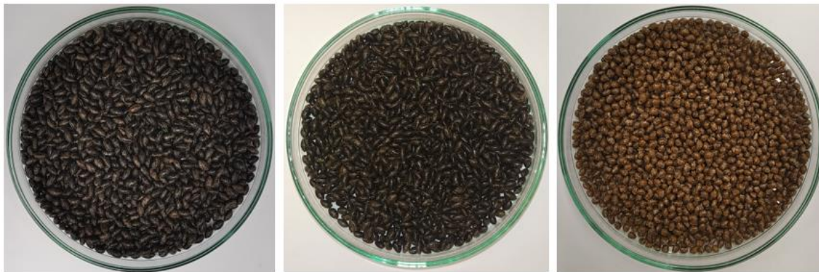
Obr. 3.12 Biopolymer PLLA s 20 hm% nemleté kávové sedliny (vlevo), s 20 hm% mleté kávové sedliny (uprostřed) a 20 hm% mletých rýžových slupek (vpravo)
