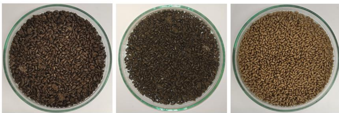
Obr. 3.13 Biopolymer PHBV s 20 hm% nemleté kávové sedliny (vlevo), s 20 hm% mleté kávové sedliny (uprostřed) a 20 hm% mletých rýžových slupek (vpravo)
