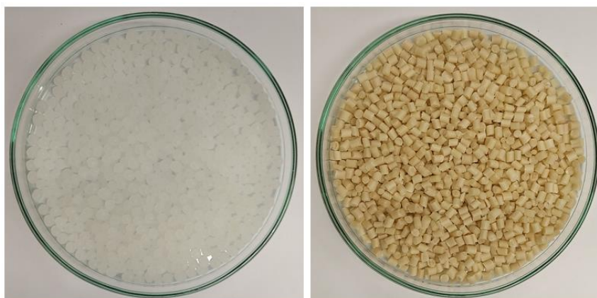
Obr. 3.1 Biopolymerní matrice v podobě granulátu pro přípravu kompozitních struktur, PLLA Luminy L130 (vlevo) a PHBV Natureplast PHI 002 (vpravo)
