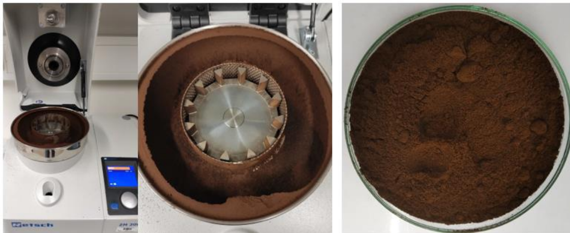
Obr. 3.4 Rotorový mlýn Retsch ZM 200 [4] a mletá kávová sedlina (KSm)
