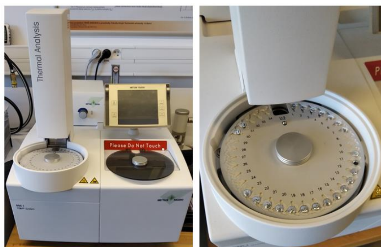
Obr. 3.18 Diferenční snímací kalorimetr Mettler Toledo DSC1/700 s detailem na zásobník s automatickým podavačem vzorků
