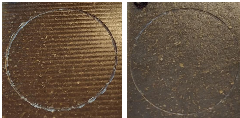
Obr. 4.18 Opotřebovaná drážka kompozitní struktury PLLA s 15 hm% RS před (vlevo) a po (vpravo) klimatickém stárnutí
