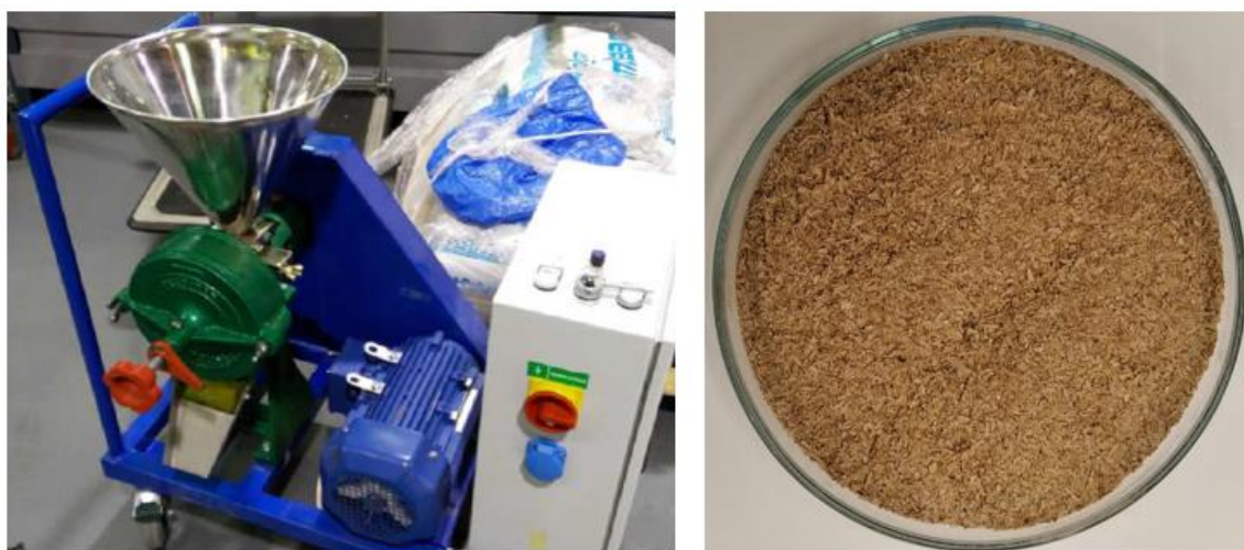
Obr. 3.9 Talířový mlýn [32] a mleté rýžové slupky
