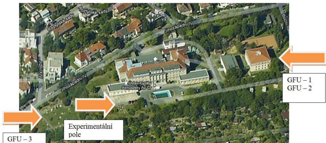
Obrázek 11-1: Rozmístění vrtů na pozemku Geofyzikálního ústavu AVČR v Praze – Spořilově [32]
