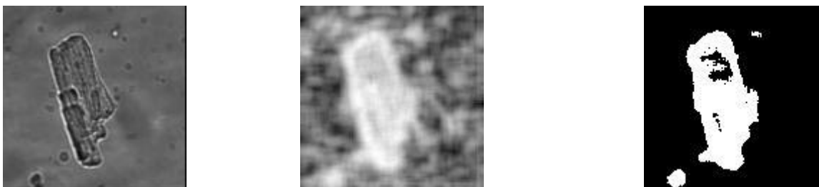
Obrázek 38 - Segmentace na základě textury v záznamu bunka6. Zleva: původní obraz, obraz po aplikování funkce entropiefilt, po prahování.
