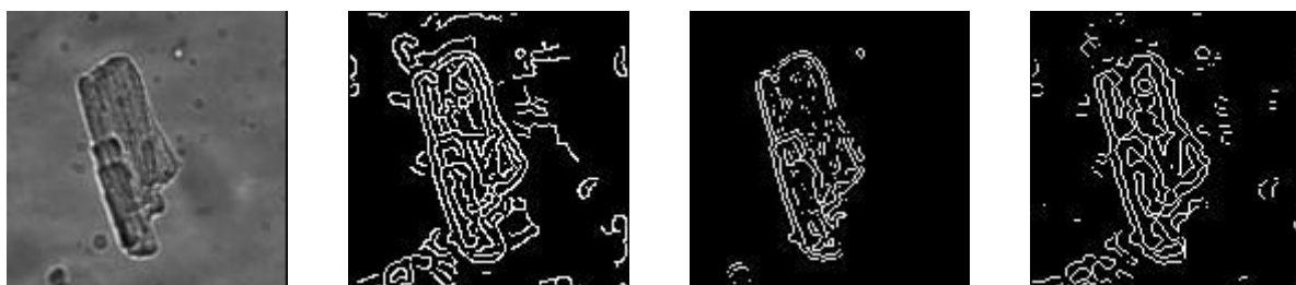
Obrázek 32 - Hranové detektory. Zleva: původní obrázek bunka6, Cannyho detektor, Sobelův detektor, Laplaceův operátor. Detekce hran proběhla po vyfiltrování obrazu, transformaci vrchní části klobouku a zvýšení kontrastu.
