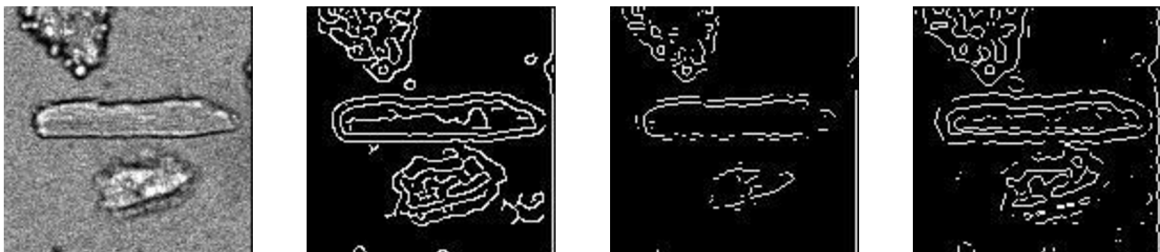
Obrázek 31 - Hranové detektory. Zleva: původní obrázek bunka5, Cannyho detektor, Sobelův detektor, Laplaceův operátor. Detekce hran proběhla po vyfiltrování obrazu.
