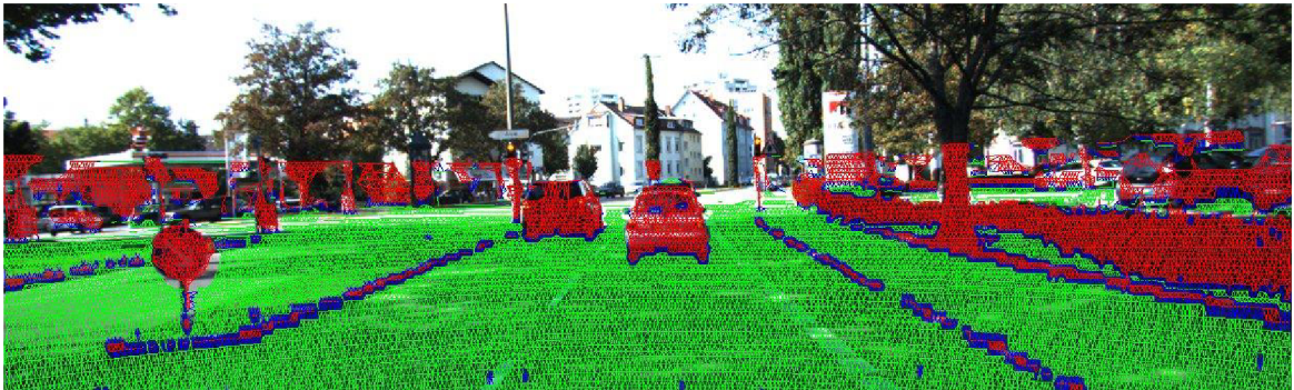
Obr. 3.1: Výsledok detekcie prekážok. Zelené body reprezentujú tie prechody kde nie sú prekážky, modré body prechod medzi prekážkou a cestou, červené body prechod v prekážke.
