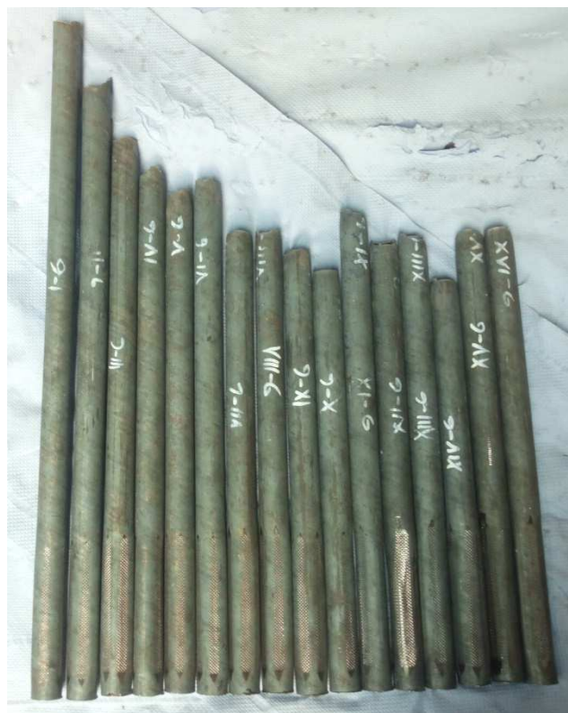
Obr. 51 Poloha lomů na přetžených tahových vzorcích po popouštění od 130 °C do 490 °C
