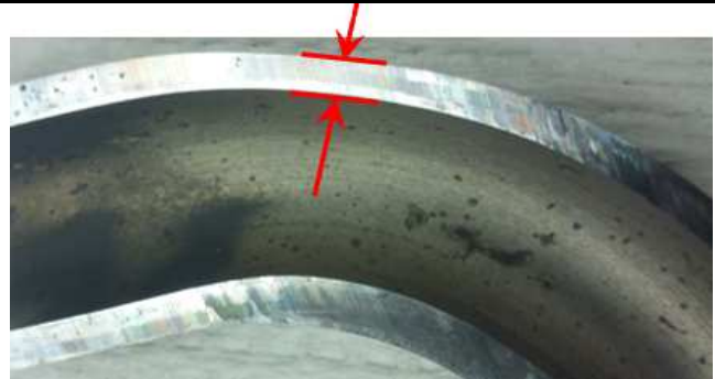
Obr. 40 Kritické místo ohybu pro měření tloušťky
