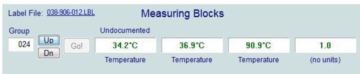
Obr. 11 Hodnoty z teplotních čidel při zahřátém motoru Teplota paliva; teplota nasávaného vzduchu; teplota chladicí kapaliny
