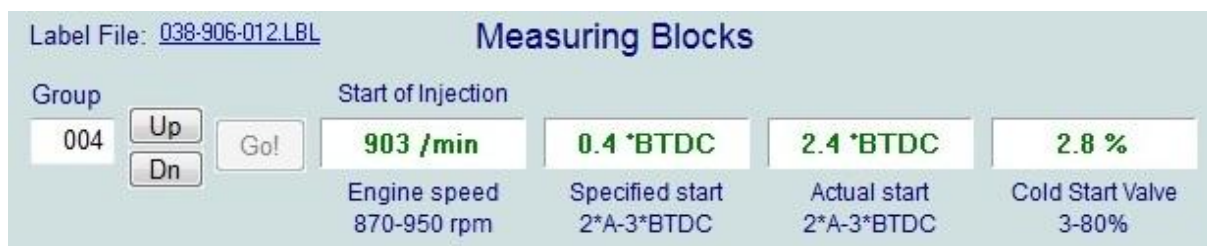
Obr. 13 Hodnoty úhlu počátku vstříku při volnoběhu Otáčky motoru; Požadovaný úhel předstříku; Aktuální úhel předstříku; Řízení ventilu počátku vstříku
