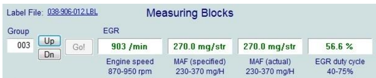
Obr. 15 Množství nasávaného vzduchu při volnoběhu Otáčky motoru; požadované množství vzduchu; aktuální množství vzduchu; nastavení řízení EGR ventilu
