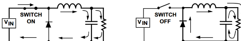
Obr. 3.5: Jednotlivé stavy spínaného regulátora [47].
