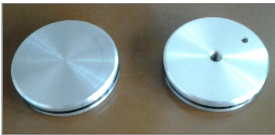
Obr. 15 Použitá víčka k utěsnění válcových konců vlnovce
