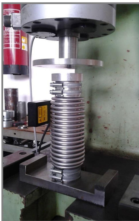
Obr. 18 Ustavení vlnovce do lisu společně s měřicími snímači
