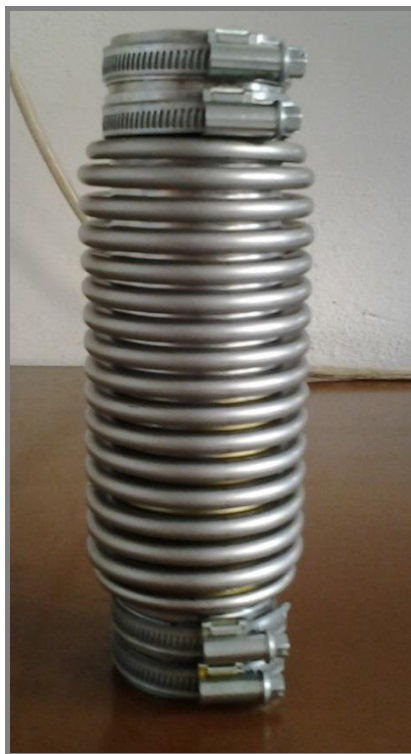
Obr. 16 Upravený vlnovec přichystaný k experimentu
