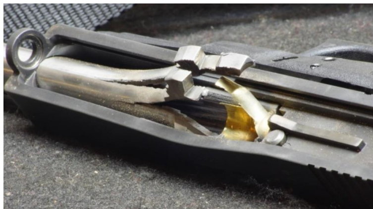
Obr. 2-5 Poškození hlavně pistole [10]
