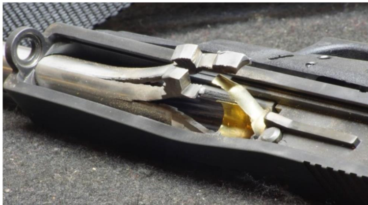
Obr. 2-5 Poškození hlavně pistole [10]
