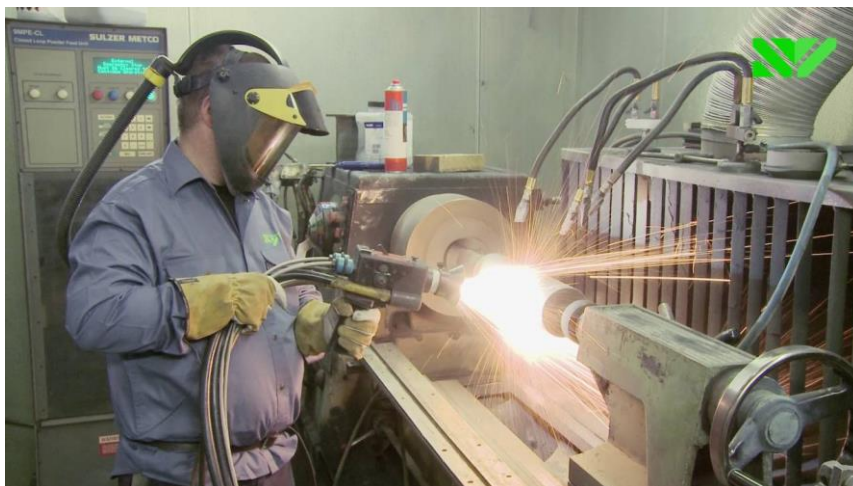
Obr. 16: Stříkání nátěru elektrickým obloukem v praxi
