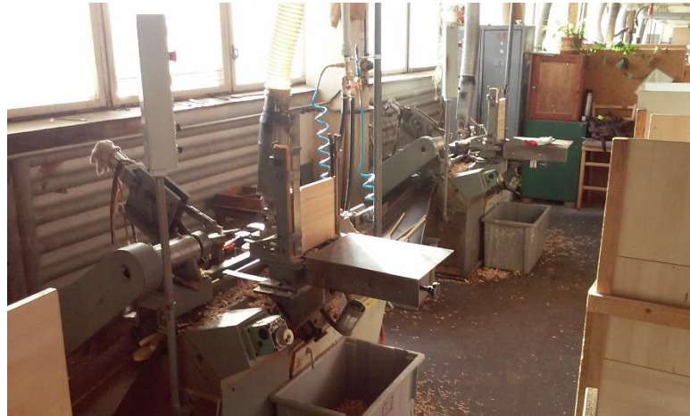
Obr. 2 Pohled na dvojici podélných soustruhů Hempel USS1
