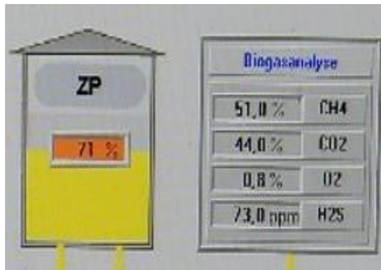
Obr. 16. Výřez operátorské obrazovky - zásobníku plynu BPS Agrodružstvo Lhota pod Libčany.
