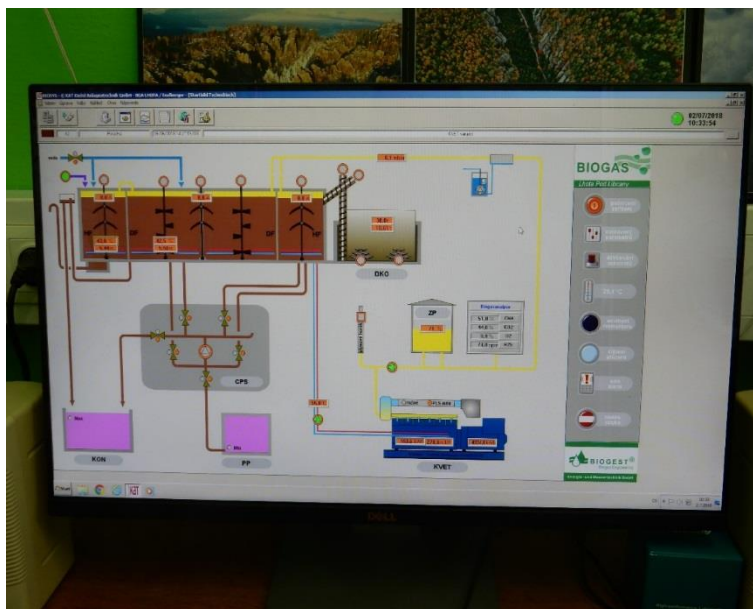
Obr. 15. Operátorská obrazovka, BPS Agrodružstvo Lhota pod Libčany [foto vlastní].
