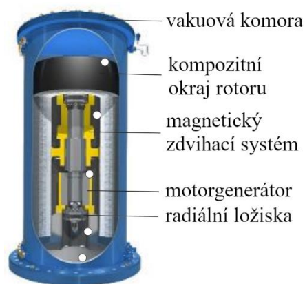
Obr. 1.12 Konstrukce setrvačnicku [25]
