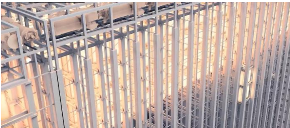
Obr. 1.23 Detail EVx: okraj zařízení s výtahy, nahoře pohony výtahů [37]
