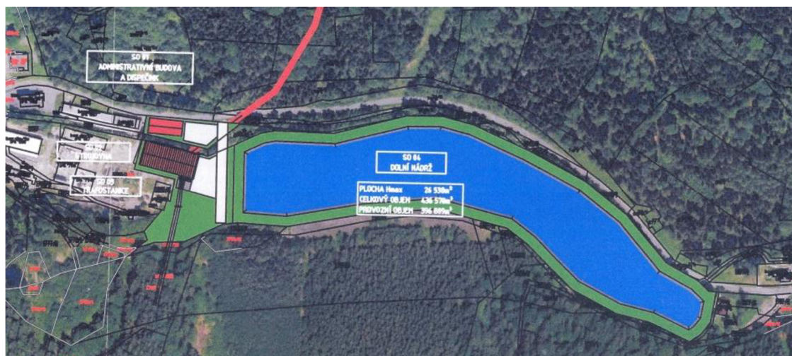
Obr. 3.3 Nákres dolní nádrže a umístění strojovny [69]
