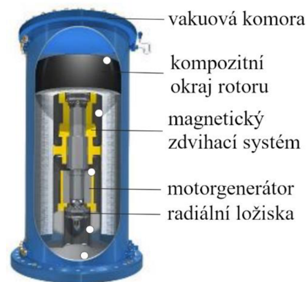
Obr. 1.12 Konstrukce setrvačnicku [25]
