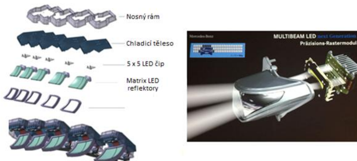
Obrázek 32 Konstrukce systému Matrix LED (vlevo) a Multibeam LED s 84 diodami (vpravo) [20], [57]
