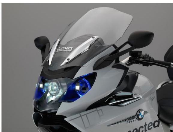
Obrázek 35 Aplikace laseru na světlomet motocyklu [80]
