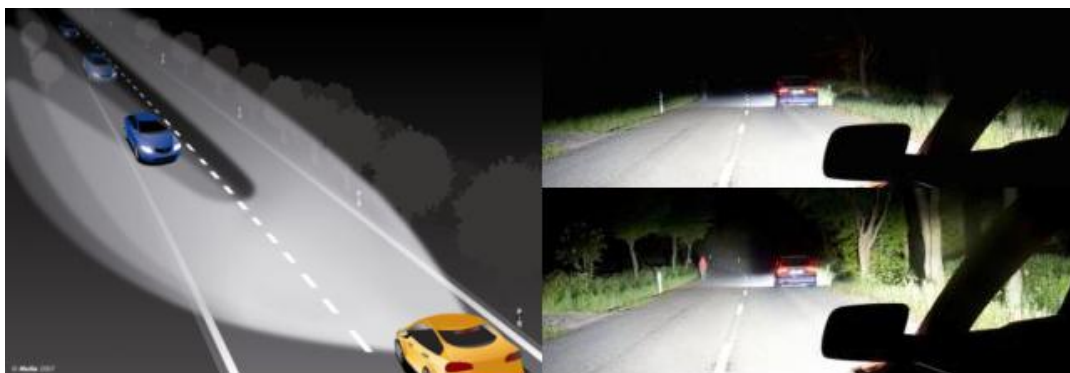
Obrázek 31 Neoslňující dálkový světlomet, vpravo nahoře jsou rozsvíceny světlomety bez neoslňující funkce, vpravo dole jsou rozsvíceny neoslňující dálkové světlomety, které výrazně lépe osvětlují chodce vlevo [20]
