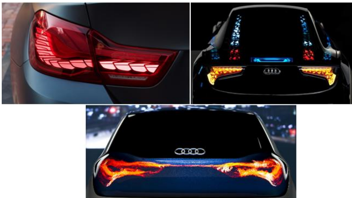
Obrázek 34 Využití OLED na vozidlech, vlevo: zadní svítlna BMW M4 GTS, vpravo a dole: futuristický koncept OLED svítlen Audi [76], [77], [78]
