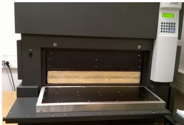
Obr. 9 Lambda-metr Netzsch s vloženým CLT panelem
