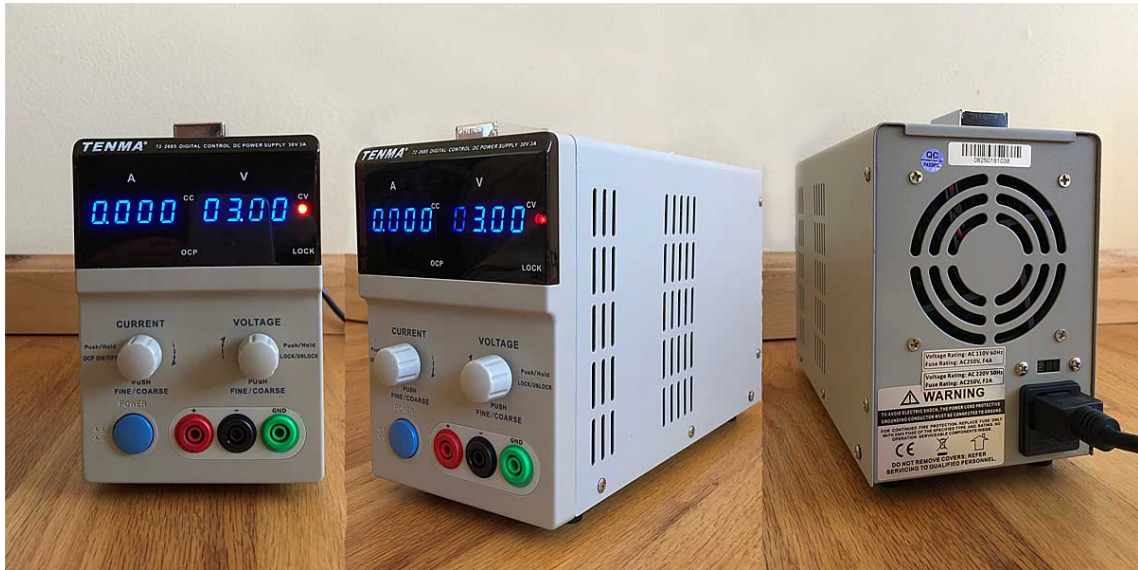
Obr. 2.3: Zdroj jednosmerného napätie TENMA 72-2685
