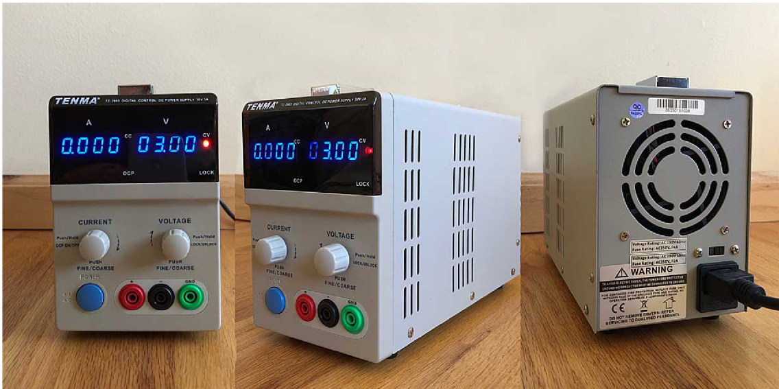
Obr. 2.3: Zdroj jednosmerného napätie TENMA 72-2685
