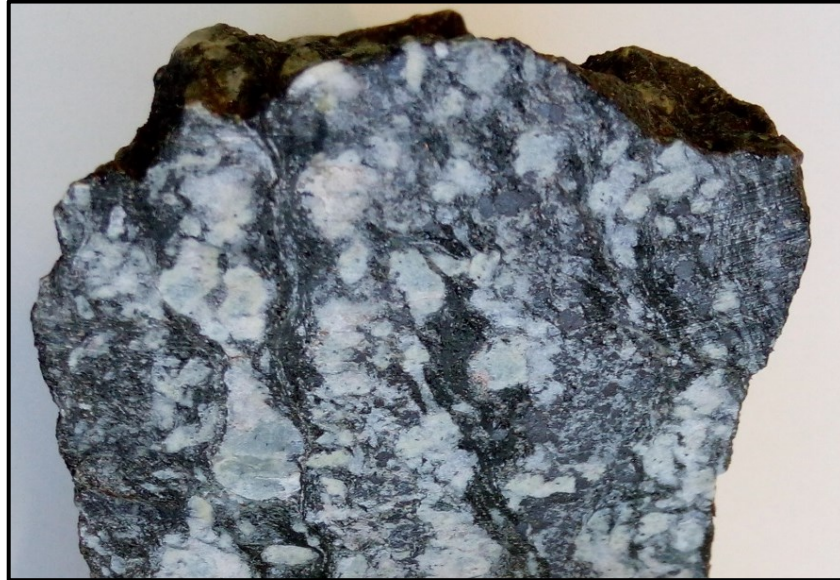
Obr. 20. Chudá magnetitová ruda s oky živců (vzorek SKV-2, typický reprezentat typu FsMgt). Šířka snímku 70 mm.
