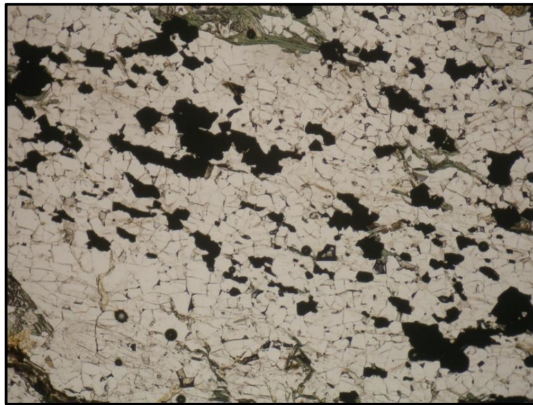
Obr. 12. Chudá křemen-magnetitová ruda. Vzorek SKV-19, typ QtzMgt. Leštěný výbrus, PPL. Šířka snímku 3 mm.
