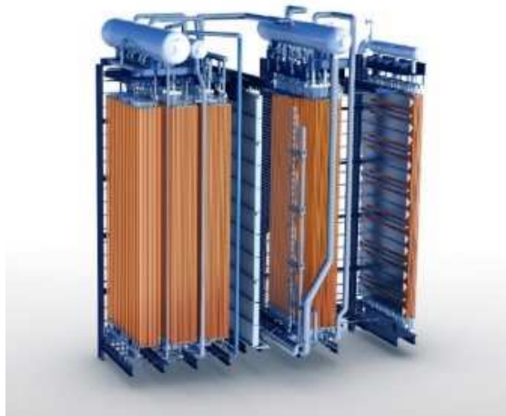
Obr. 4.1 Ukázka výhřevných ploch ve spalínovém kanále [1]
