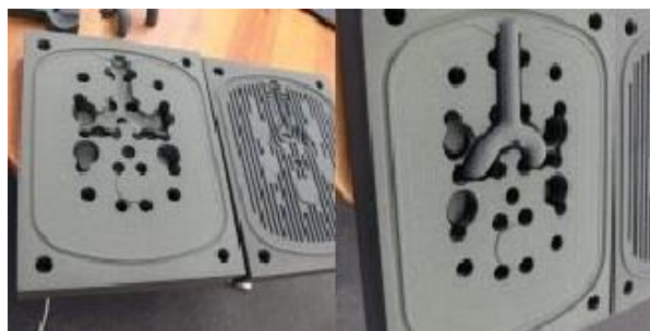
Obrázek 22 vytištěné jádro ve vytištěné formě [27]
