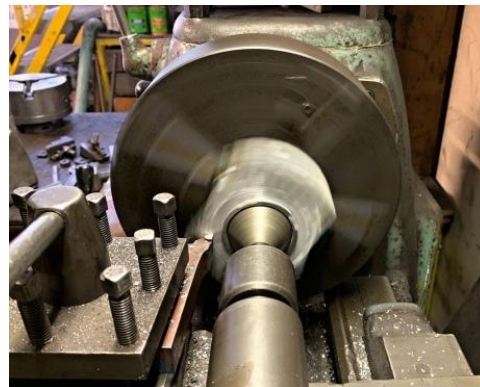
Obrázek 36 soustružení spodní strany žebër
