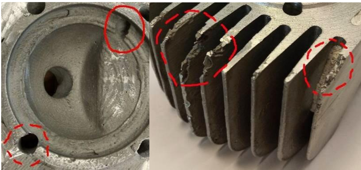
Obrázek 41 vady v okolí spalovacího prostoru Obrázek 40 vady na spodní straně žebér
