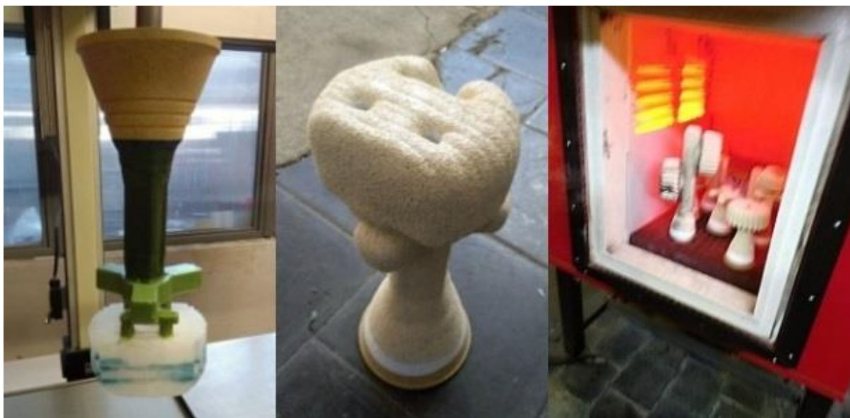
Obrázek 32 zleva: model s vtokovou soustavou na stroji Cyclone, vyrobená skořepina, vytavování modelů v peci
