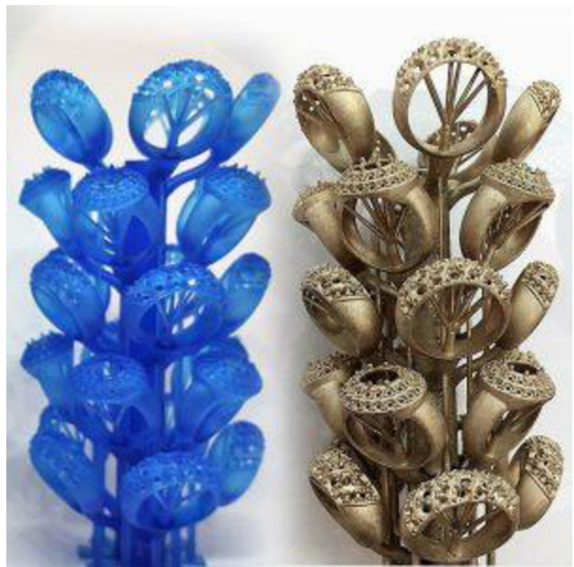
Obrázek 27 stromeček modelů a odlitků technologie SLA [38]
