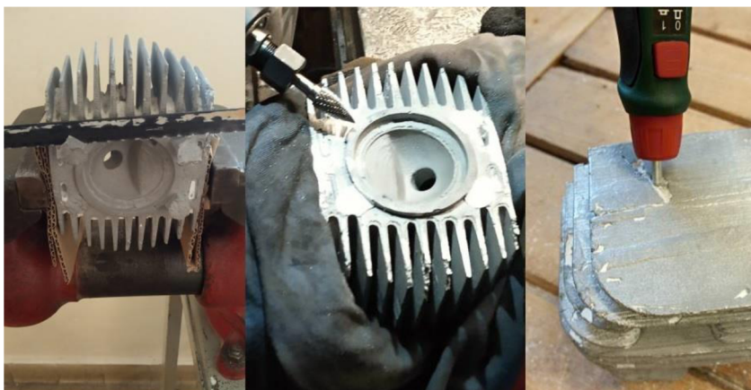
Obrázek 35 čištění odlitku, zprava: odstranění, zabroušení vtoků, odstranění zbytků keramiky
