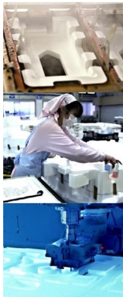
Obrázek 12 možnosti výroby EPS modelů [18] [19]
