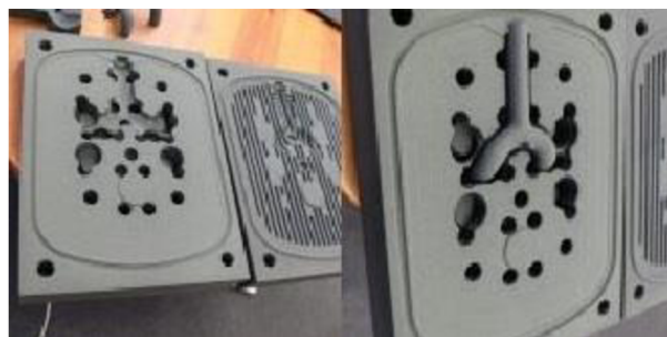
Obrázek 22 vytištěné jádro ve vytištěné formě [27]
