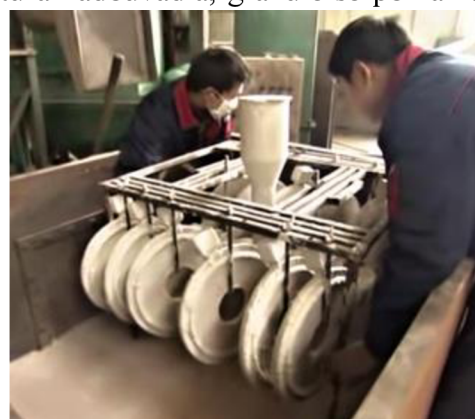
Obrázek 14 formování stromečku pro Lost foam [22]
