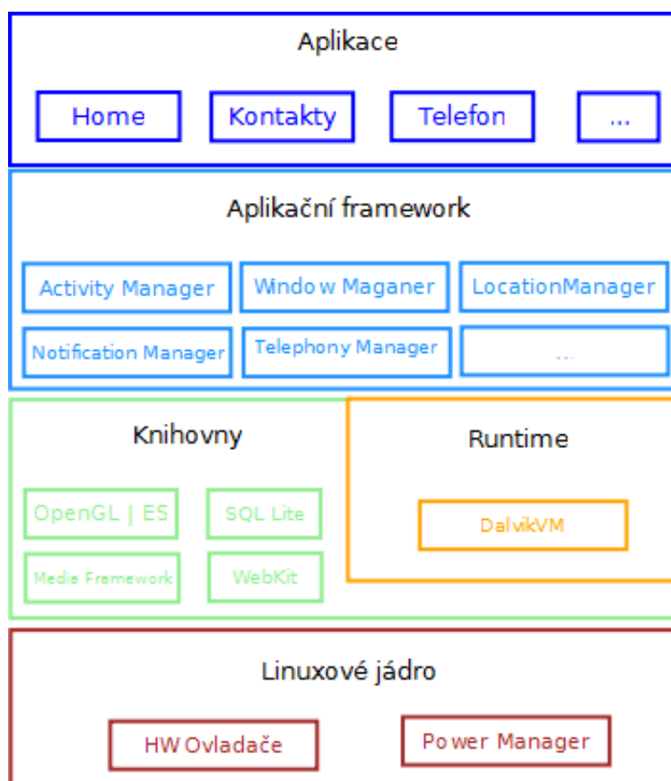
Obrázek 3.1: Android: schéma architektury.
