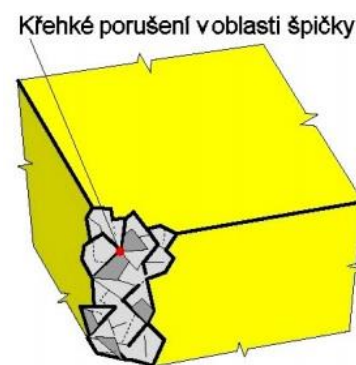
Obr. 11 Schéma křehkého lomu [3, s. 43]
