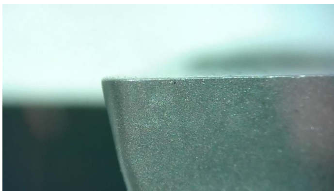
Obr. 23 Opotřebení VB 0,0 mm
