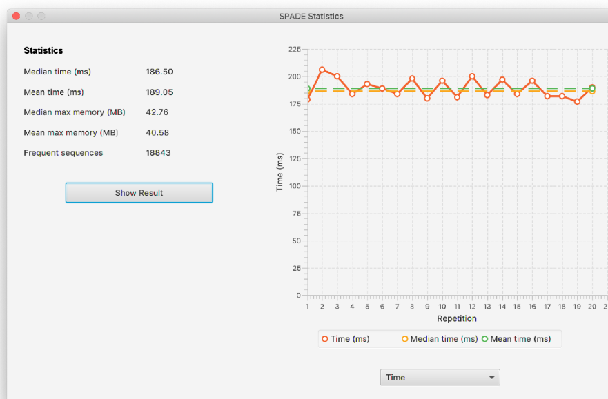
Obr. 4.2: Okno so štatistikami o behu algoritmu. Pomocou rozbaľovacej ponuky v spodnej časti okna je možné zobrazit graf časovej alebo pamäťovej spotreby. Po kliknutí na tlačidlo Show Result je otvorené okno 4.3.
