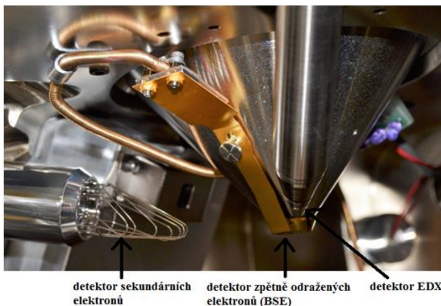
Obr. 10) Komora elektronového mikroskopu s popisem detektorů
